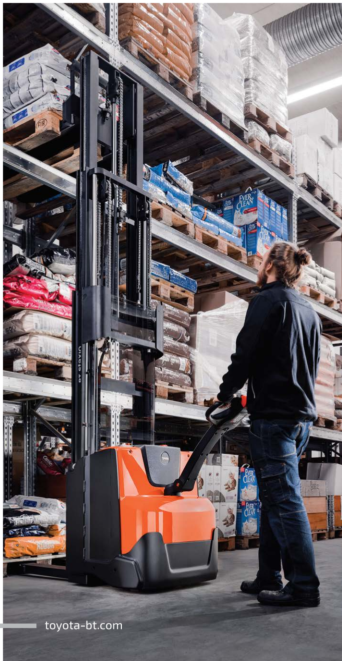
Рукоятка оптимизирована для безопасной работы и защищает ноги оператора от наезда
